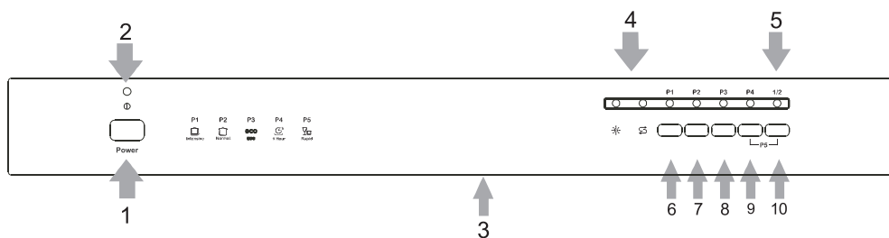
Панель управления (Рис. 3)
