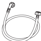
Шланг подачи воды
