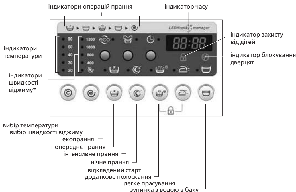
Рисунок 3 – Зони індикації і кнопки вибору додаткових функцій
