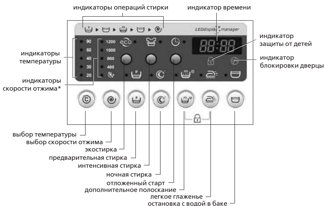
Рисунок 3 — Зоны индикации и кнопки выбора дополнительных функций
