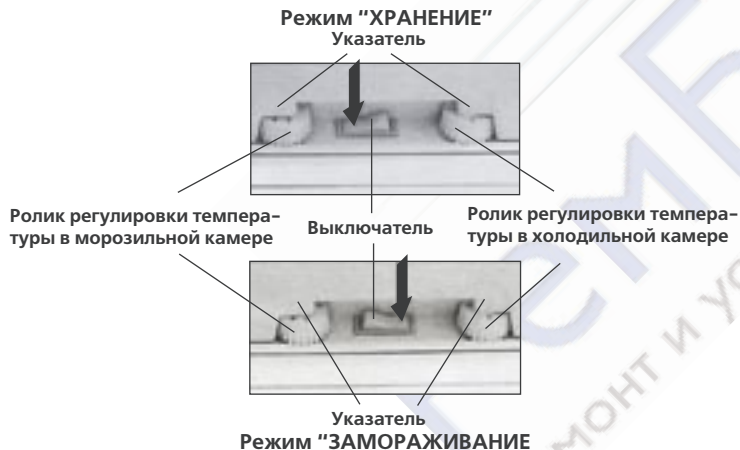
Рисунок 4 — Схема переключения режимов
