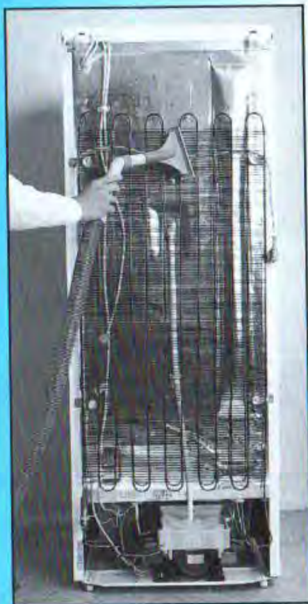
Рисунок 2 - Уборка холодильника (вид сзади)
