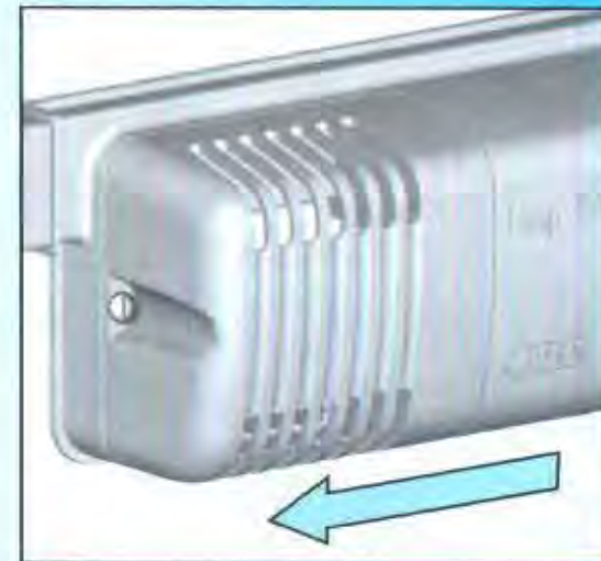
Рисунок 9 - Схема для снятия плафона
