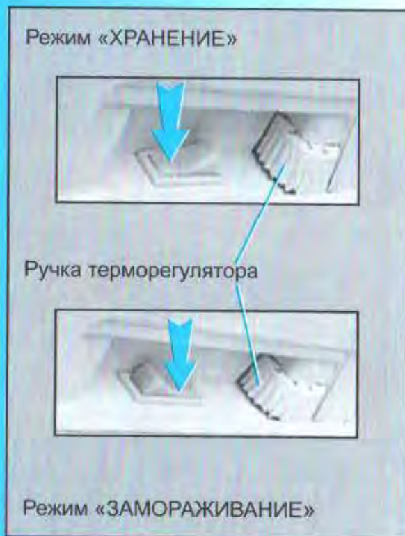
Рисунок 5 - Схема расположения переключателя режимов
