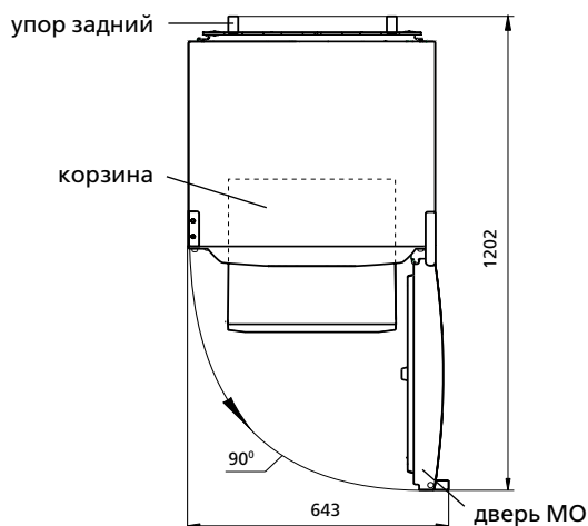
Рисунок 2 – Холодильник (вид сверху)
