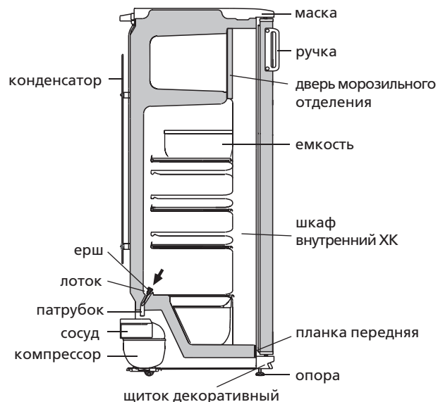
Рисунок 4 — Схема слива талой воды из ХК
