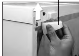
Рисунок 2 — Схема установки упора заднего
