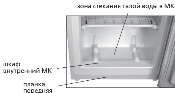
Рисунок 8 — Сбор талой воды из МК
