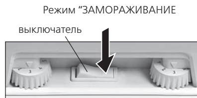
Рисунок 9 — Схема переключения режимов в холодильнике однокомпрессорном
