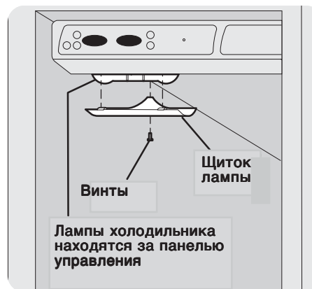
Замена ламп холодильника
