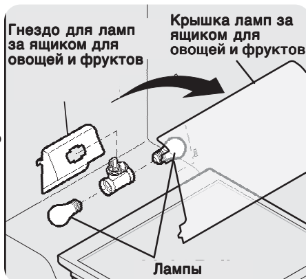
Замена ламп отсеков для овощей и фруктов (могут быть разными в разных моделях)
