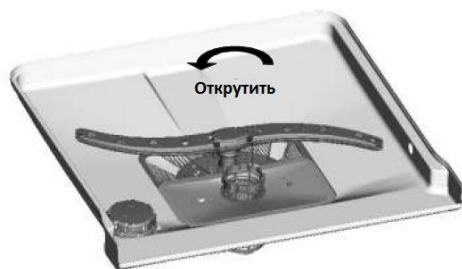
Шаг 1: Поверните фильтр против часовой стрелки.
