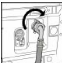
Заливной шланг подсоединяется наверху, справа
