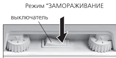
Рисунок 9 — Схема переключения режимов в холодильнике однокомпрессорном
