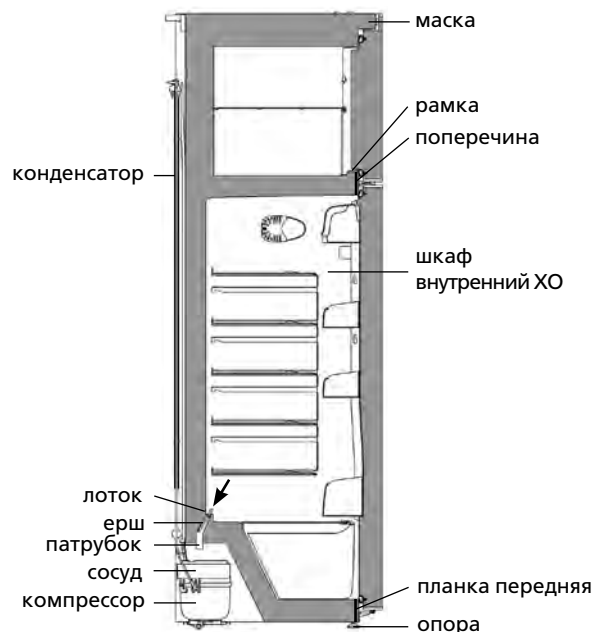
Рисунок 4 — Схема слива талой воды из ХО
