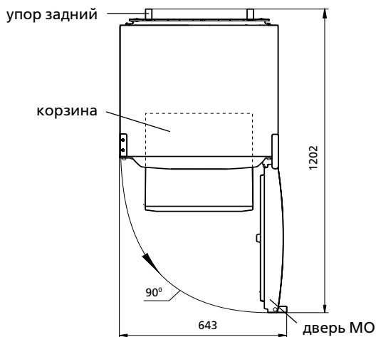
Рисунок 2 – Холодильник (вид сверху)
