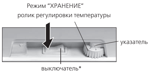
Рисунок 9 — Схема переключения режимов в холодильнике однокомпрессорном
