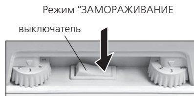
Рисунок 9 — Схема переключения режимов в холодильнике однокомпрессорном
