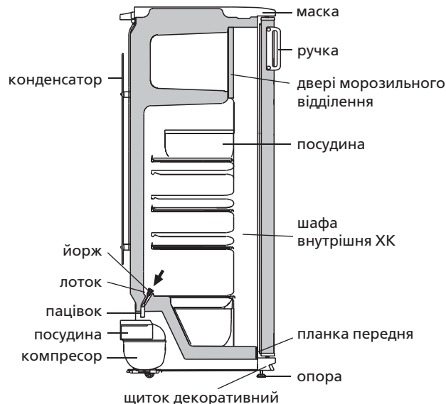
Рисунок 4 — Схема сливу талої води із ХК
