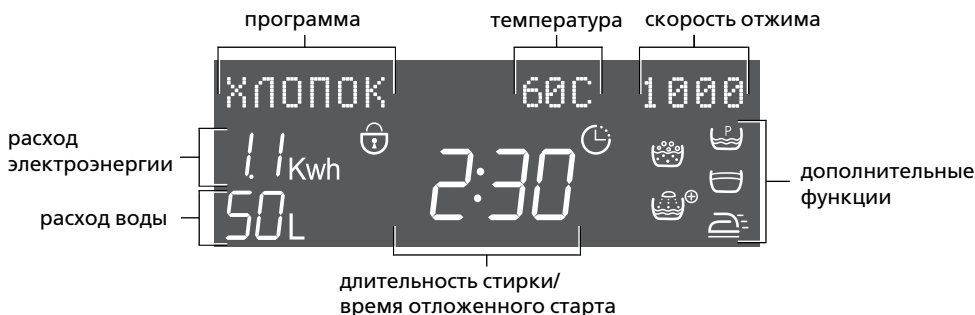
Рисунок 2 — Зоны индикации дисплея
