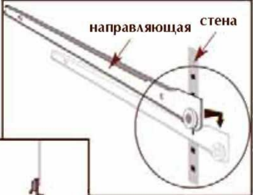
Регулировка передней части направляющей
