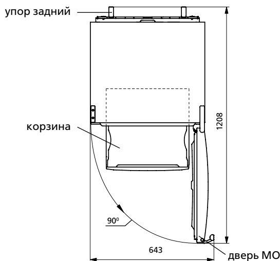
Рисунок 2 – Холодильник (вид сверху)
