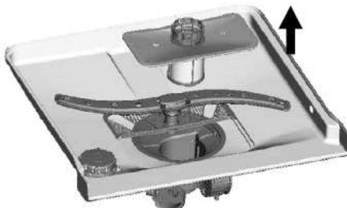
Шаг 2: Выньте фильтр движением вверх
