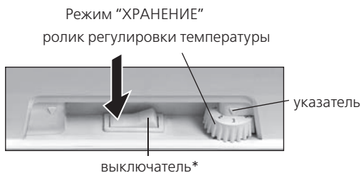
Рисунок 9 — Схема переключения режимов в холодильнике однокомпрессорном
