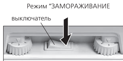
Рисунок 9 — Схема переключения режимов в холодильнике однокомпрессорном
