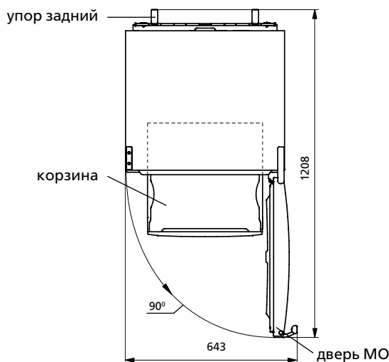
Рисунок 2 – Холодильник (вид сверху)
