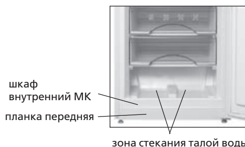
Рисунок 6 — Сбор талой воды из МК
