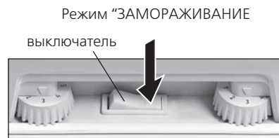
Рисунок 9 — Схема переключения режимов в холодильнике однокомпрессорном
