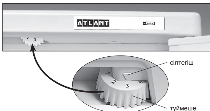
3 сурет — Температураны реттеу
