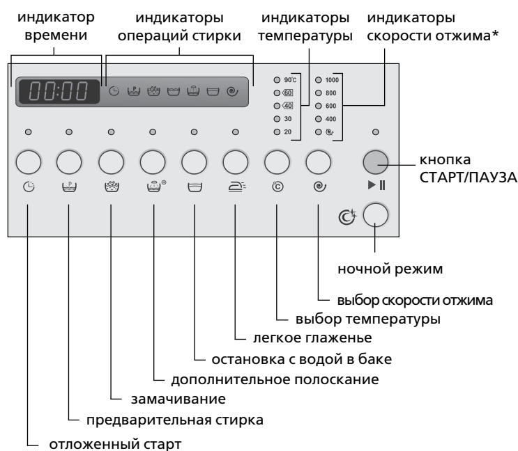
Рисунок 3 – Зоны индикации и кнопки управления
