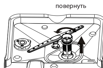
Шаг 1 - Поверните верхнюю часть блока фильтров против часовой стрелки
