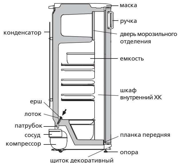
Рисунок 4 — Схема слива талой воды из ХК
